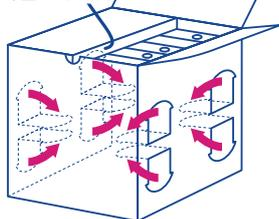
4つの注水口に、注水用具の先端を差し込み、水を500mlずつ注入します。
